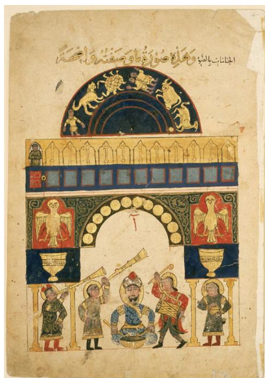
شکل شماره (۱): نمای ساعت دیاربکر از کتاب فی المعرفة الحیل الهندسیه اثر بدیع الزمان الجزری. حیوانات و انسان‌های تصویر عروسک‌های متحرک و نوازنده ساعت‌اند (current, 10 junauray, 2010)
